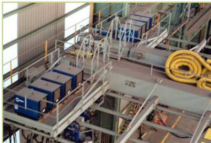
■ EQUIPEMENTS DE SOUDURE INSTALLÉS SUR LE PONT
