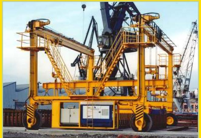
■ SYSTÈME DE MOUFLAGE 16/8 AVEC CÂBLES CROISÉS POUR ÉVITER LE BALANCEMENT DE LA CHARGE ET PALONNIER AVEC ROTATION
