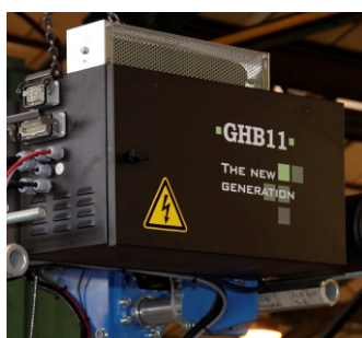
17 / Elektrischer Schaltschrank für Seilzug
