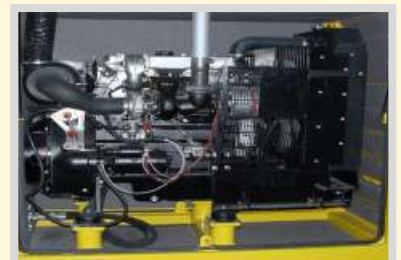
Bastidor de motor aislado acústicamente
