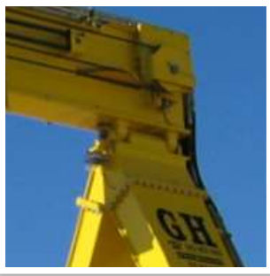
ESTRUCTURA CON UNIÓN ARTICULADA
