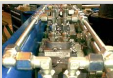
Distribuidores hidráulicos con válvulas de seguridad
