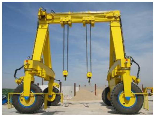
MANIPULACIÓN DE CABEZAL DE EÓLICO
