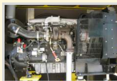
Motor diesel refrigerado
