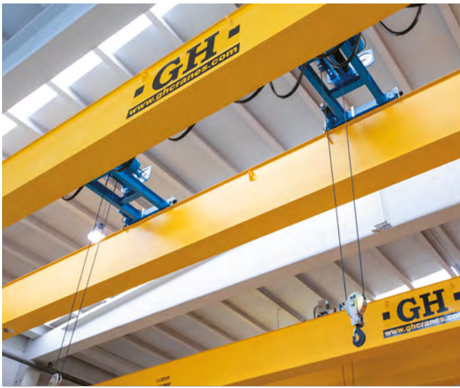
PONT ROULANT AVEC DEUX PALANS
