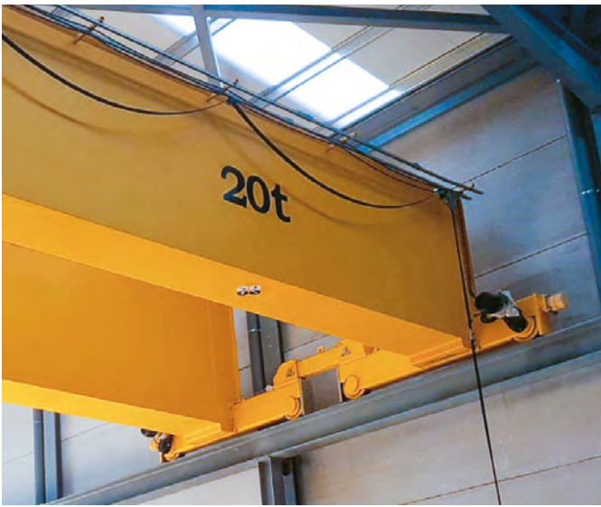
PONT ROULANT À DOUBLE SOMMIER (HUIT GALETS)
